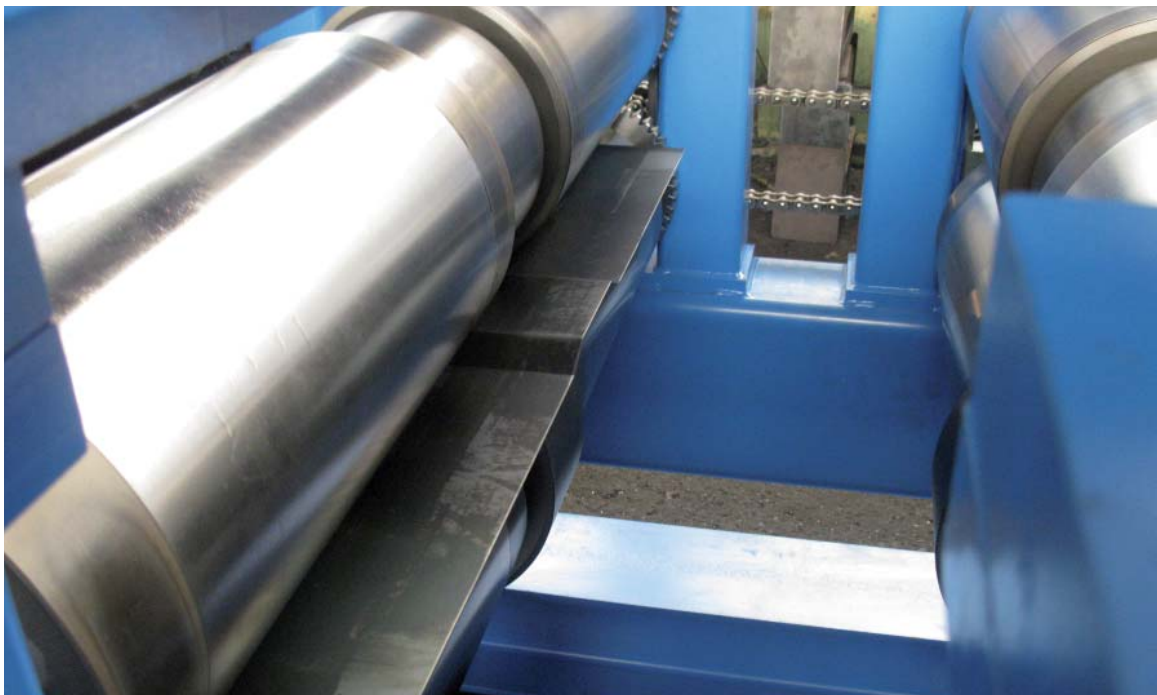
Rolki dociskowe w modułach profilarki w trakcie produkcji
