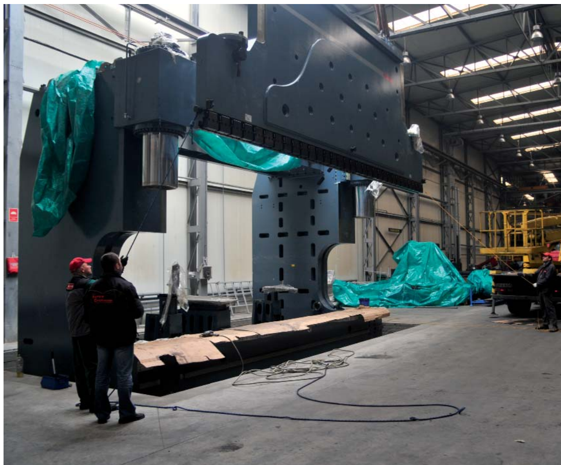
Osadzenie belki suwaka w korpusie prasy krawędziowej
