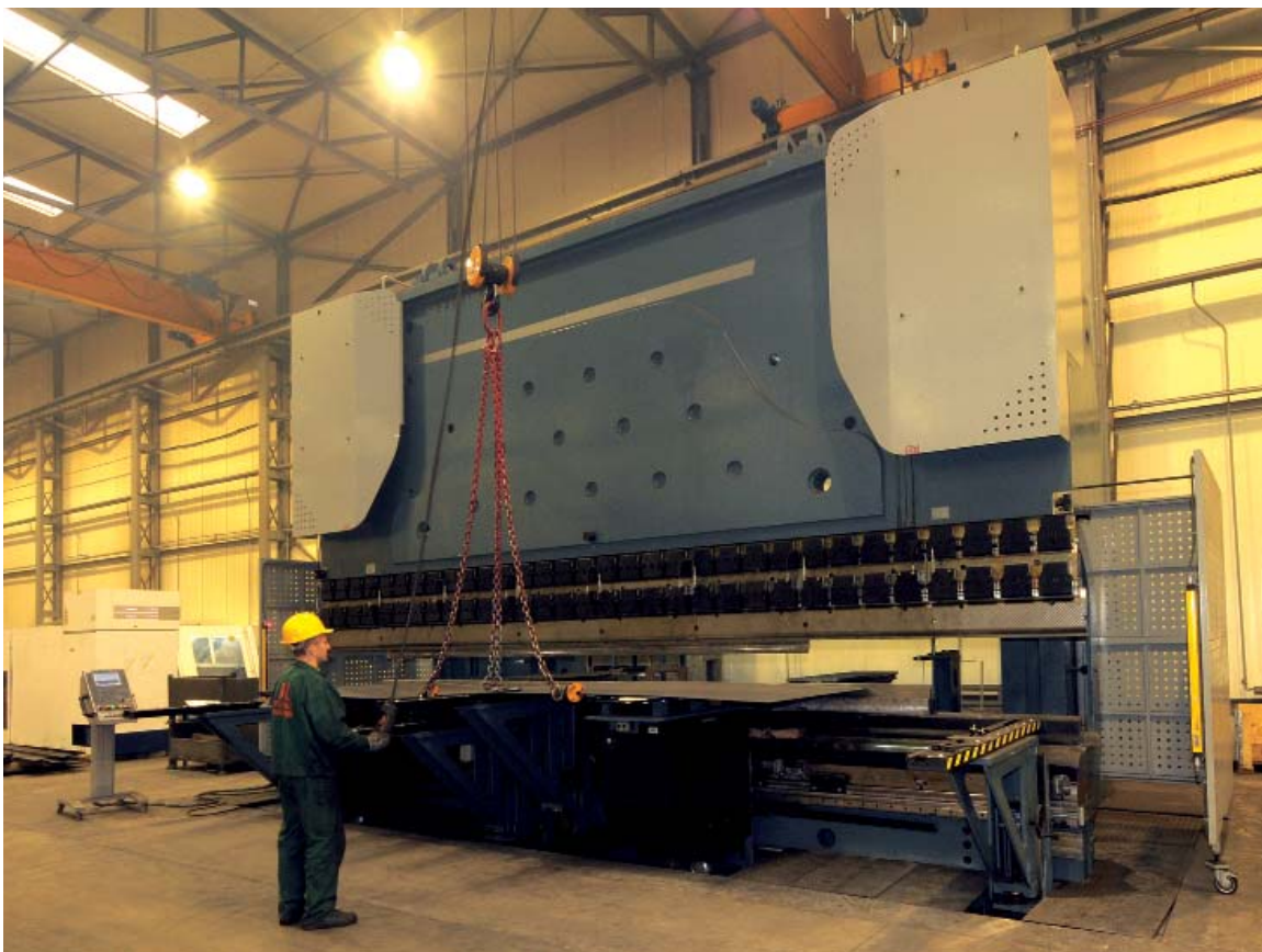
Prasa krawędziowa podczas zaginania detalu wymagającego dużej precyzji gięcia
