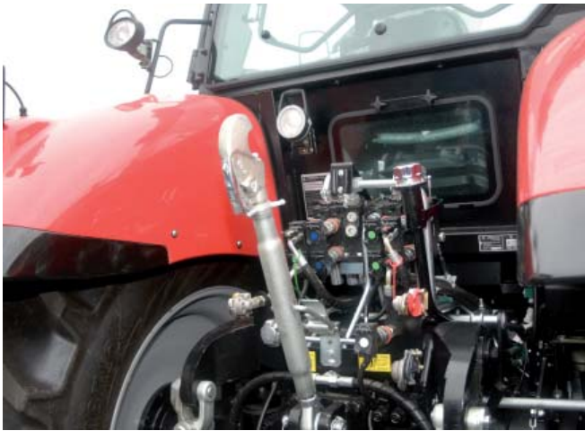
Wlew oleju przekładniowego w ciągnikach PRONAR 8140, produkowanych w oparciu o układy napędowe marki ZF, znajduje się w tylnej części ciągnika
