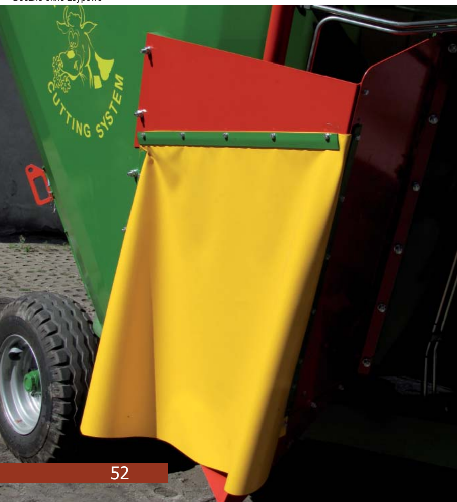
Boczne okno zsypane
