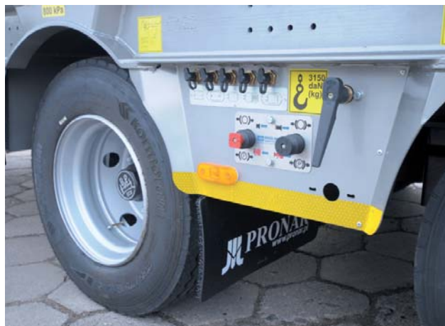
„Pulpit” sterowniczy z umieszczonymi zaworami: hamulcowym i podnoszenia/opuszczania platformy oraz z wyprowadzonymi na zewnątrz złączami kontrolnymi
