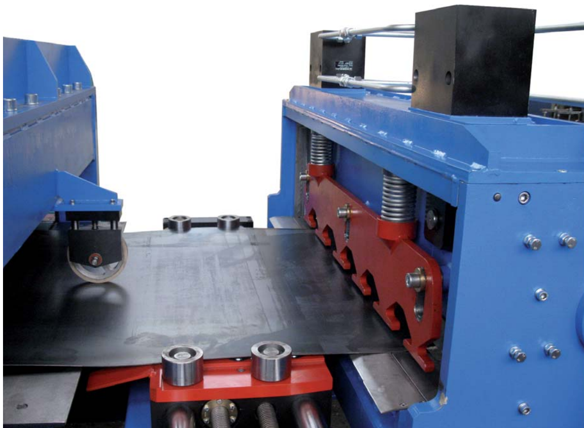
Prostownica prostuje pasmo blachy oraz likwiduje naprężenia wewnętrzne
