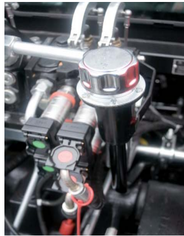
Korek wlewu oleju przekładniowego powinien być utrzymany w czystości
