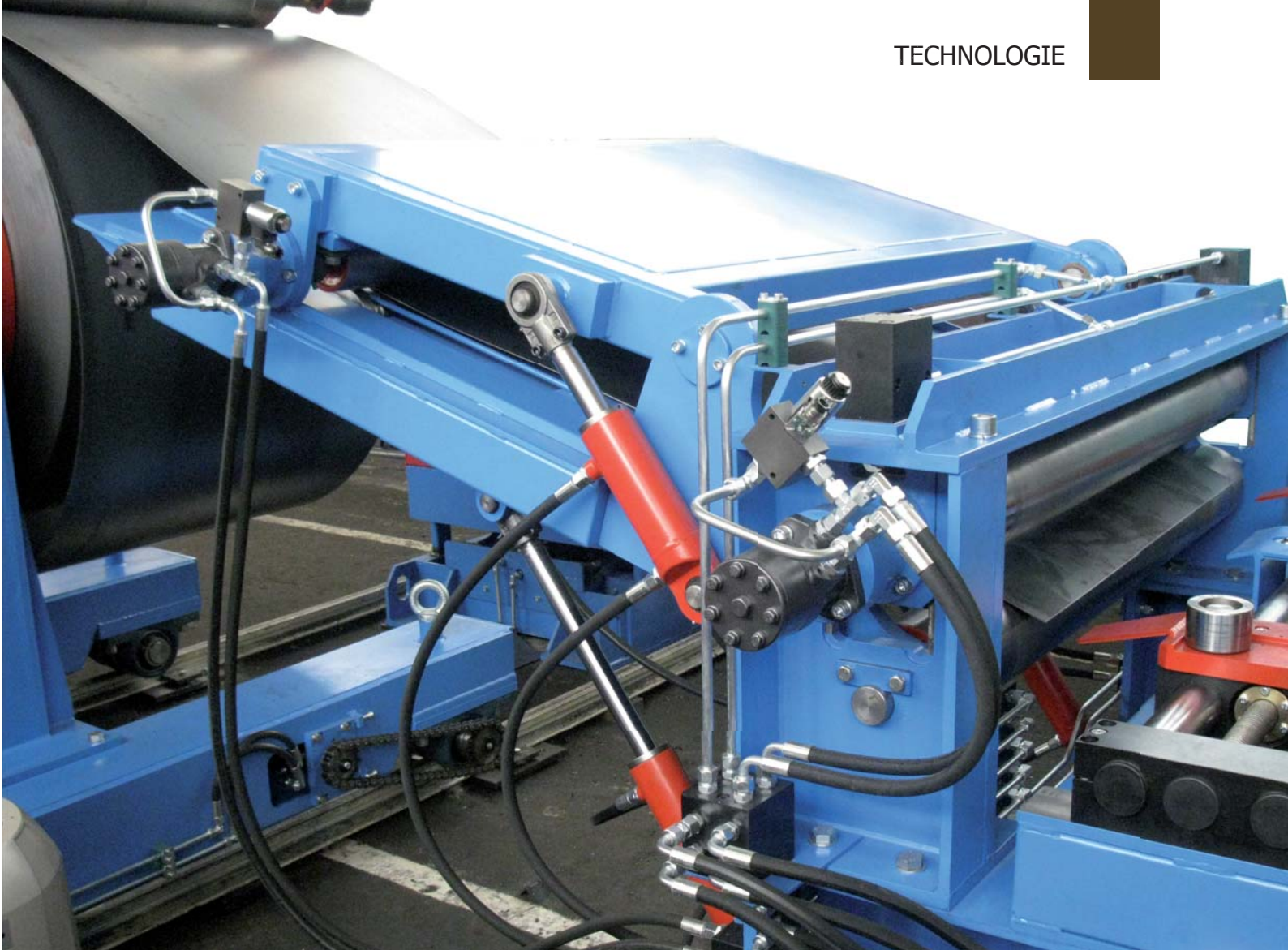
Ruchome hydrauliczne ramię pomaga umieścić rozwiniętą blachę w układzie wlotowym
